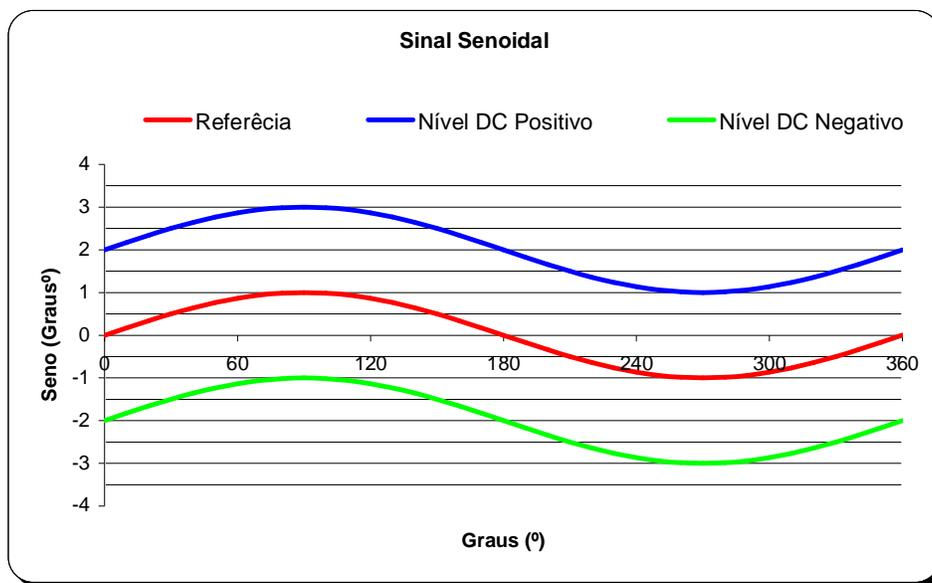
Figura 1.3 – Diferentes níveis DC em um sinal senoidal
